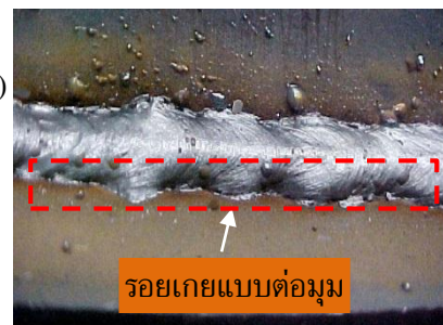
(ข) รอยเกยแนวเชื่อมแบบต่อมุม (Overlap fillet weld)
