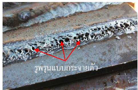
รูปที่ 8.39 ลักษณะรูปแบบการเกิดรูพรุนแบบกระจายตัวในแนวเชื่อม
