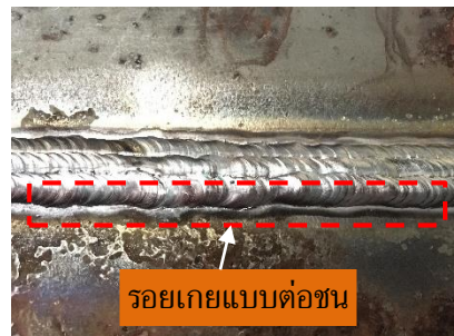
(ก) รอยเกยแนวเชื่อมแบบต่อชน (Overlap butt weld)
