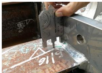
รูปที่ 8.81 การตรวจสอบข้อบกพร่องรอยขอบเชื่อมเยื้องเชิงมุมด้วยเกจวัด ที่มา : G.A.L. Gade Co.-Hi-Lo Welding gage, 2011
