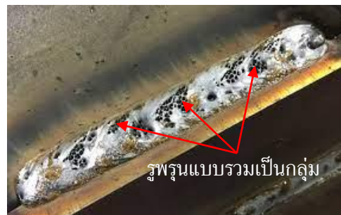
รูปที่ 8.40 ลักษณะรูปแบบการเกิดรูพรุนแบบรวมตัวเป็นกลุ่มในแนวเชื่อม
