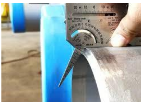
(ก) การเตรียมบารรอยต่อโลหะงานที่จะเชื่อม
