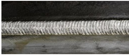
(ก) แนวเชื่อมที่หลอมลึกไม่สมบูรณ์แบบต่อชน
