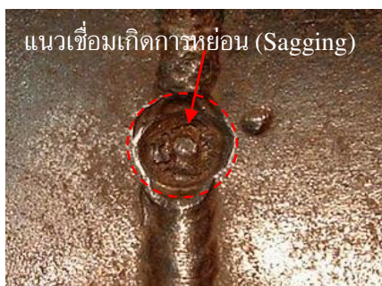
(ข) การหย่อนตัวเชื่อมโลหะแผ่นหนา
