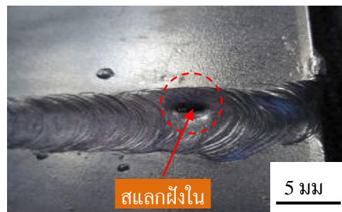
(ข) สแลกฝังในแบบเปิดผิว (External defect)
