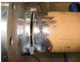
การเชื่อมยึด (Tack weld)
