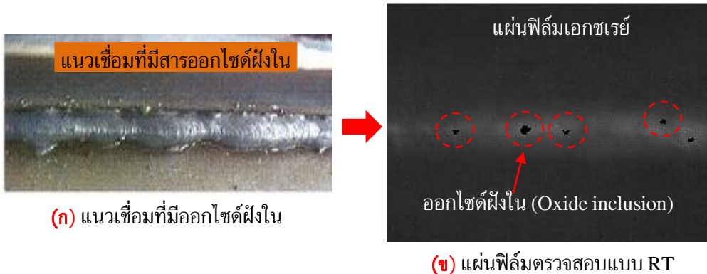
รูปที่ 8.51 ตัวอย่างชิ้นงานเชื่อมและแผ่นฟิล์มตรวจสอบที่มีสารออกไซด์ฝังตัวในแนวเชื่อม
