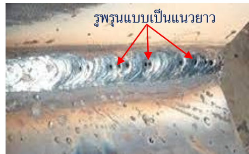
รูปที่ 8.41 ลักษณะรูปแบบการเกิดรูปพรุนแบบเป็นแนวยาวในแนวเชื่อม
