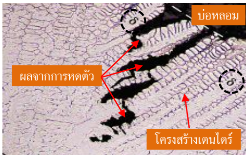
รูปที่ 8.47 การหดตัวจากการเกิดของเฟส เดลตาเฟอร์ไรต์ในโครงสร้างเดนไดรของการเชื่อมเหล็กกล้าไร้สนิมออสเทนนิติก
