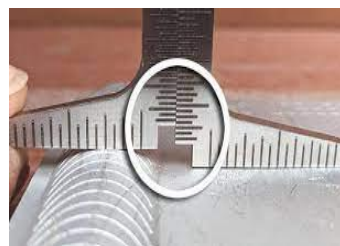
รูปที่ 8.81 การตรวจสอบข้อบกพร่องรอยขอบเชื่อมเยื้องเชิงมุมด้วยเกจวัด ที่มา : G.A.L. Gade Co.-Hi-Lo Welding gage, 2011
