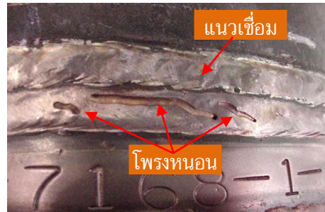
(ก) โพรงหนอนของการเชื่อมแบบต่อชน
