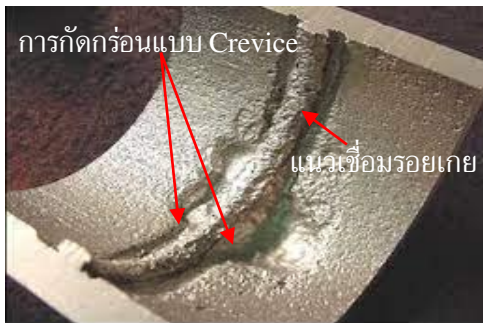
รูปที่ 8.69 การกัดกร่อนแบบ Crevice ที่เกิดจากข้อบกพร่องรอยเกยของแนวเชื่อม
