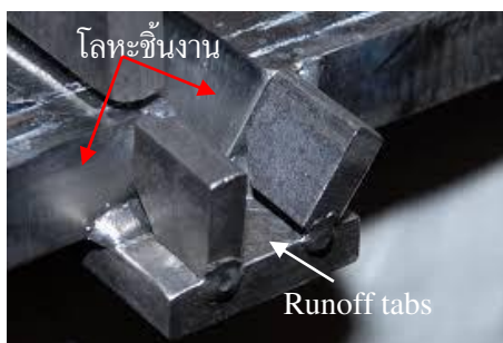
(ข) การสร้าง Runoff tab โลหะแผ่นหนา
