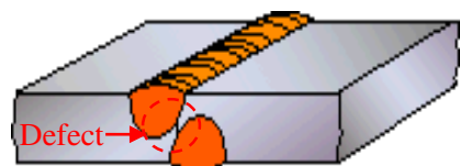
(ข) หลอมลึกไม่สมบูรณ์แบบรอยบากเอียง
