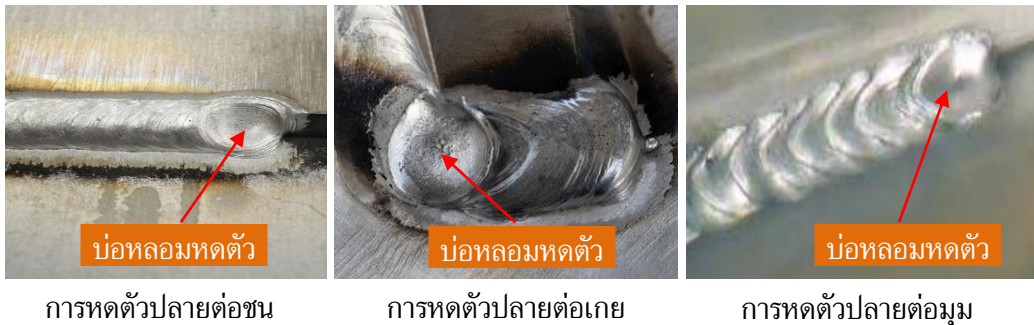
รูปที่ 8.45 ตัวอย่างลักษณะรูปแบบโพรงหดตัวของรอยต่อต่างแบบที่ปลายสิ้นสุดแนวเชื่อม
