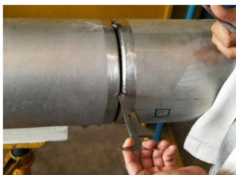
(ข) การเชื่อมแทครอยต่อโลหะงานที่จะเชื่อม
