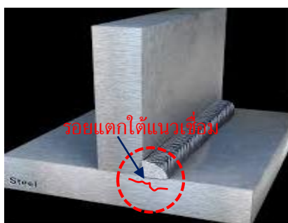
รูปที่ 8.8 ตำแหน่งและลักษณะของรอยแตกร้าวชนิดที่แตกใต้แนวเชื่อม (Underbead crack)
