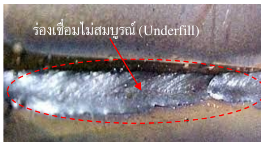
รูปที่ 8.71 ลักษณะของการเกิดข้อบกพร่องที่เติมเนื้อเชื่อมไม่สมบูรณ์ (Underfill)
