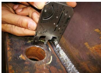
รูปที่ 8.81 การตรวจสอบข้อบกพร่องรอยขอบเชื่อมเยื้องเชิงมุมด้วยเกจวัด ที่มา : G.A.L. Gade Co.-Hi-Lo Welding gage, 2011
